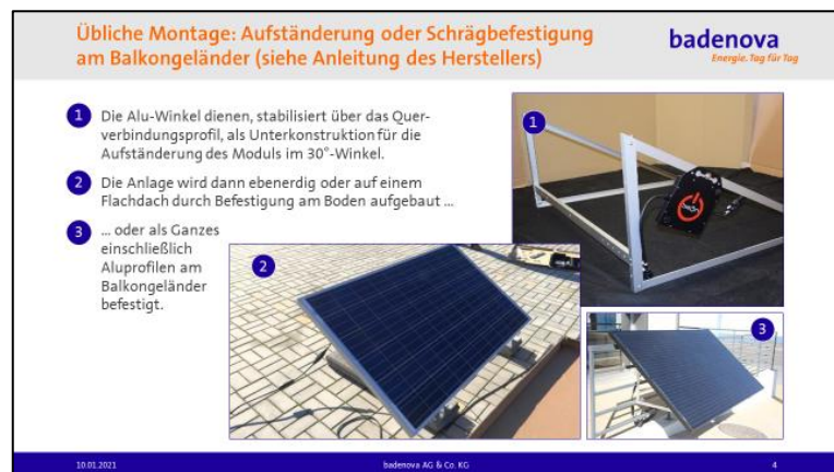
Abbildung 8: Befestigungsalternativen beim im Projekt verwendeten BeOn-Befestigungsset
